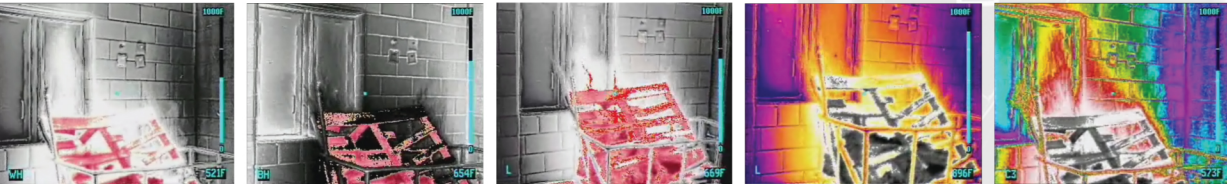
白热化图像 黑热化图像 冰火化图像 火熔图像 多彩图像
